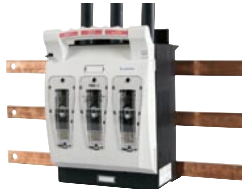
RBK 2-V-SG (odejście kablem z góry) RBK 2-V-SD (odejście kablem z dołu) wykonanie do montażu na szynach zbiorczych z zaciskiem kablowym typu V
