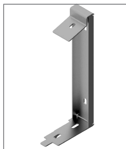
Uchwyt panela prawy UPP15W2 Materiał: Stal S355 cynkowana metodą zanurzeniową PN-EN ISO 1461:2011
