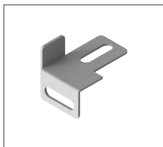
Uchwyt krzyżowy UKPNF - 32 szt. Materiał: Stal S235 cynkowana metodą zanurzeniową PN-EN ISO 1461:2011
